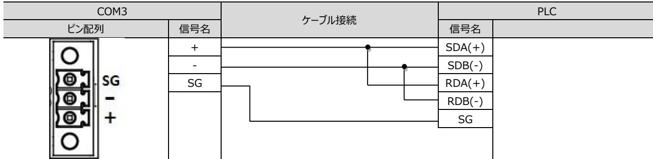
■ RS-422 (1:N接続) – 1:1接続を参考にして、以下の方法で接続してください。
