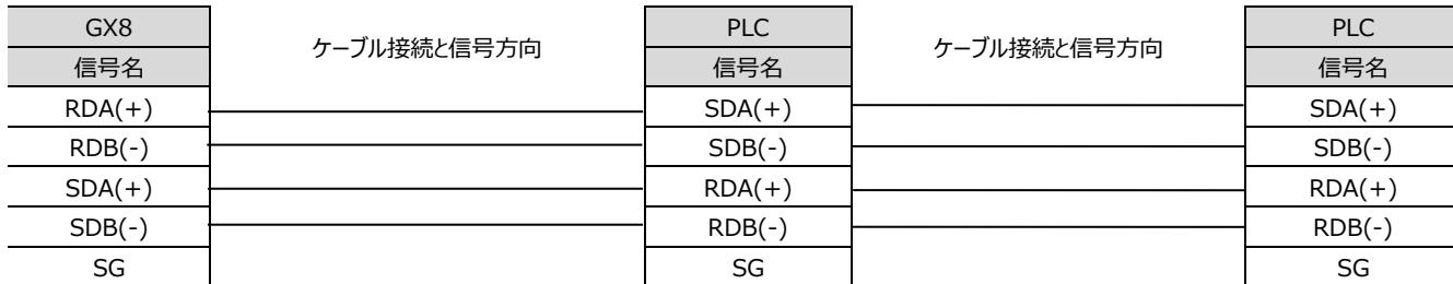
■ RS-485 (1:N/N:1接続) 1:1接続を参考にして、以下の方法で接続してください。
